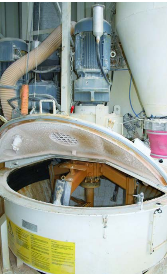
Новый конусный смеситель Kniele объемом 750 л с встроенной системой очистки
