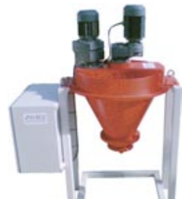
Stacjonarna wersja podstawowa z kubłem o pojemności 25 l.
