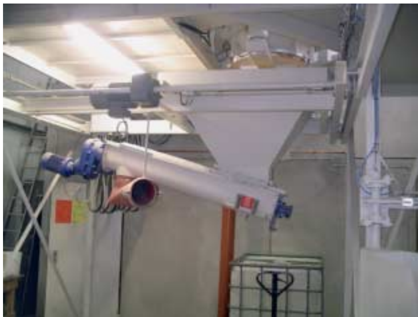
Fig. 3 Movable downstream silo. Abb. 3 Verfahrbares Nachsilo.
