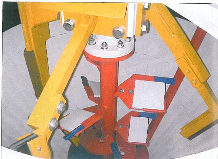
Intérieur de la cuve du malaxeur conique Kniele.
