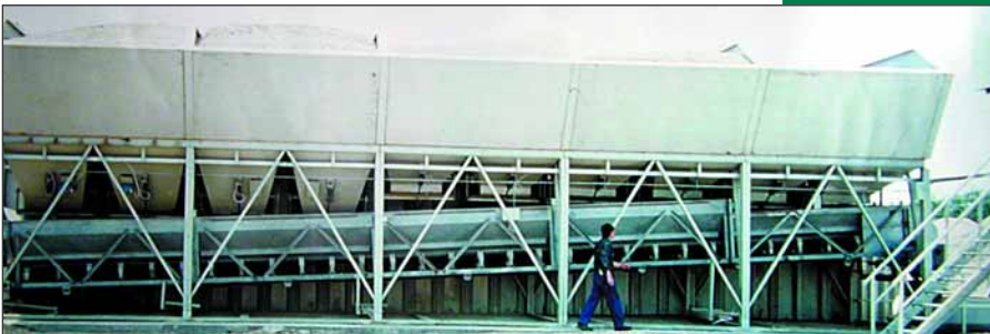
Silos en ligne avec bande de pesage
