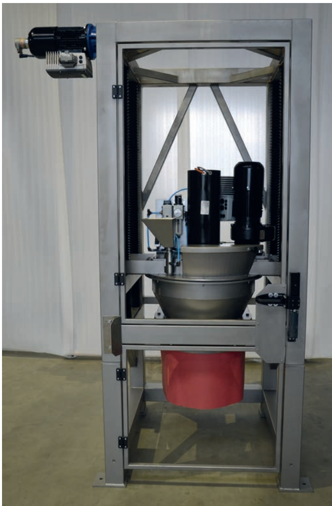
Gesamtdarstellung des neuen Labor-Intensivmischers KKM-RT 15/22.5 mit integriertem Rheometer und Tribometer
