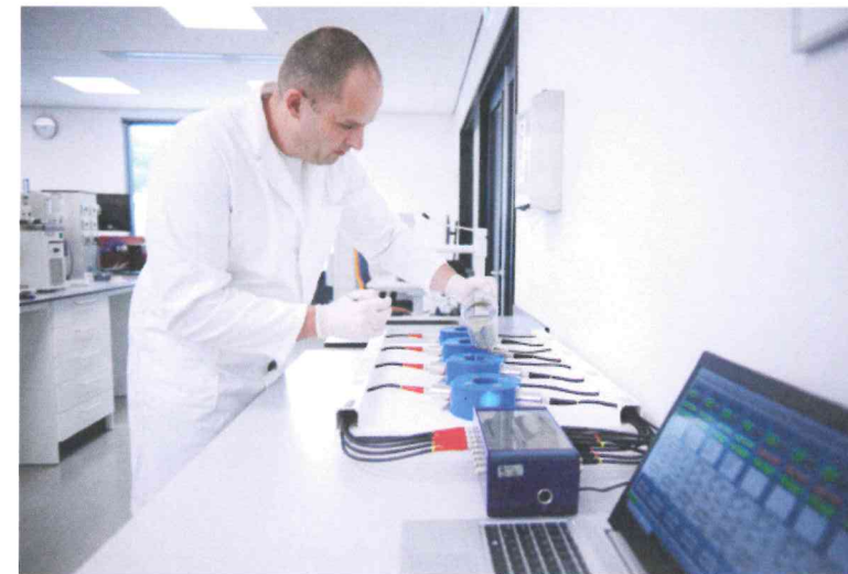
Der Ultraschall-Tester dient der präzisen Darstellung des Abbindeprozesses des Betons.
