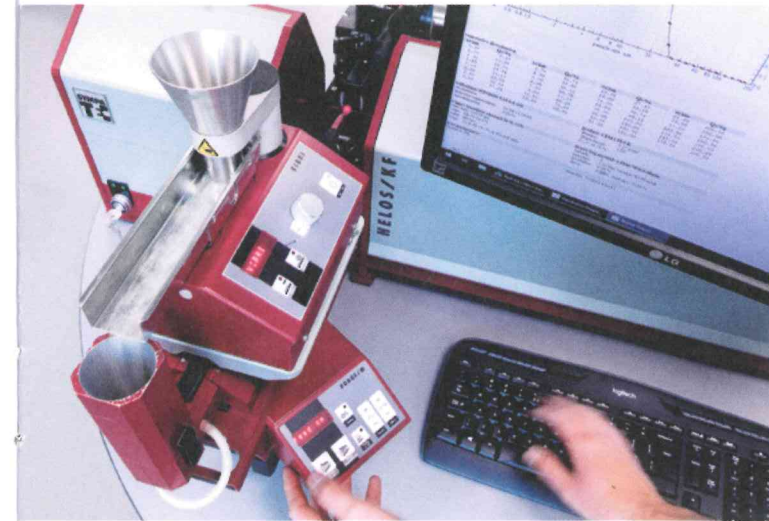
Untersuchung der Partikelgrößenverteilung mittels Laserbeugung.
