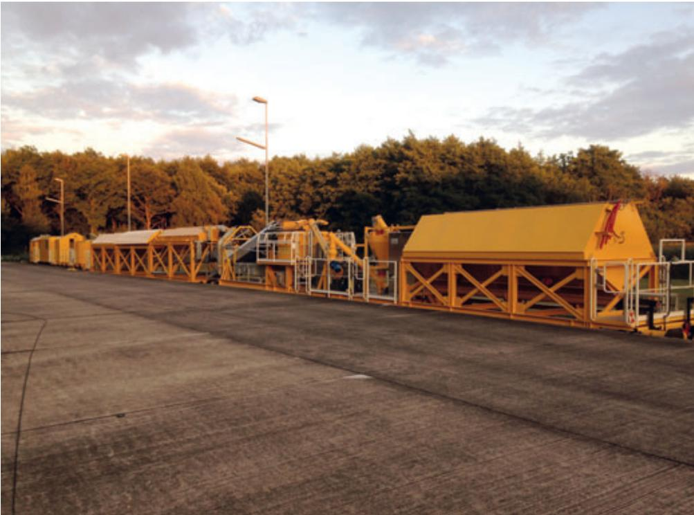
Die gesamte Mischanlage ist mit einem Dieselstromaggregat selbstversorgend ausgerüstet und kann eine gesamte Schicht lang eingesetzt werden, ohne dass eine externe Stromzufuhr oder eine zusätzliche Anlieferung von Rohstoffen erforderlich ist.
