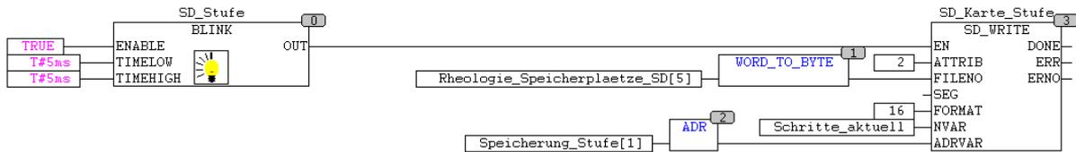
Bild 4.9: CFC-Programm zur Speicherung der aktuellen Stufe [0-7], die während des tatsächlichen Mischvorgangs im Takt von 250 ms festgehalten wird.
