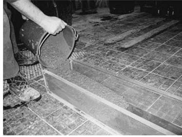
Bild 5.3: Langsames Einfüllen eines SVB in die LCPC Box [7]
