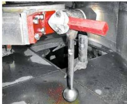
Bild 2.41: Viscoprobe in einem Couvrot Planeten-Mischer mit 1.5 m<sup>3</sup> Mischvolumen [70]
