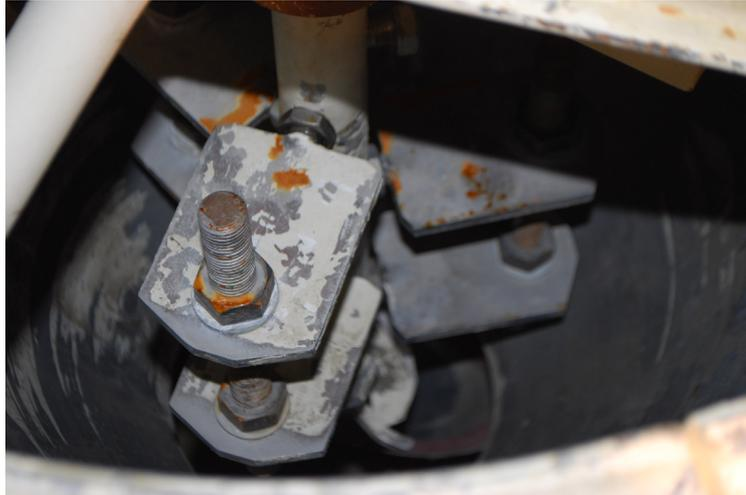
*Bild 6.22: Stiftwirbler abgeleitet aus dem Standard-Werkzeug*
