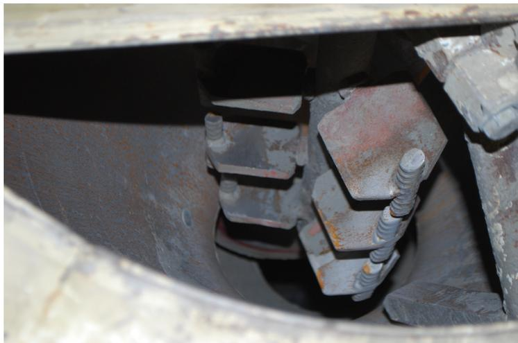
*Bild 6.23: Standardwerkzeug des KKM 30 ergänzt um Stifte an den Außenkanten*
