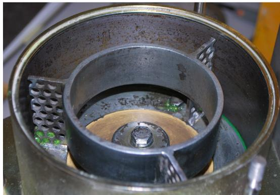
*Bild 2.9: Perforierter Blattrührer in der Mischzelle eines 5 l Labor-Suspensions-Mischers*
