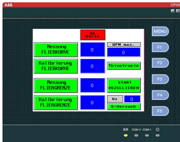
Bild 6.6: Menü-Unterpunkt RHEOLOGIE: Eingabe der Maximaldrehzahl [UPM] für die Fließkurven, der Frequenz [Hz] für den Amplituden-Test, den Speicherplätzen auf der SD-Speicherkarte sowie Start-Buttons für die genannten Versuche
