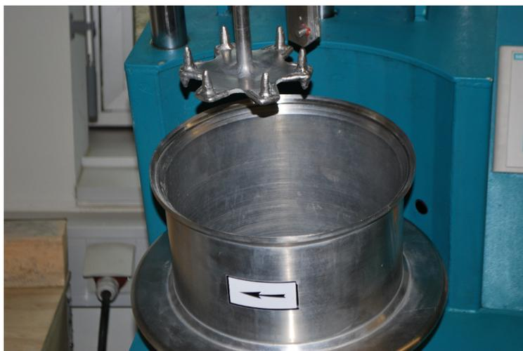
*Bild 2.8: Labor-Intensiv-Mischer, Typ Eirich mit einem Nennvolumen von 5 l und einem Stiftwirbler*
