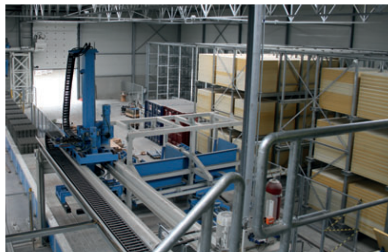
Paketierer Servo 700 von Hess auf der Trockenseite, Formenregal und Brettstaplerregal
