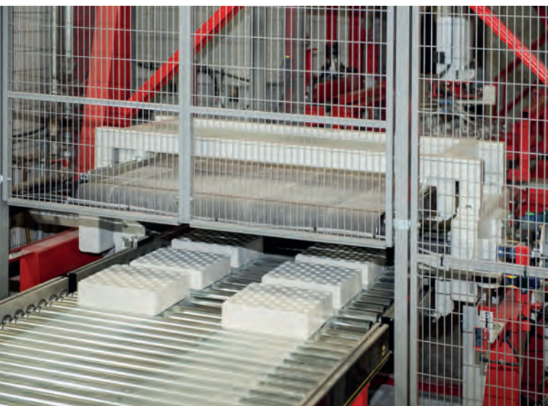
Auch bei Palettenbelegung mit mehreren Produkten ist die Entschalung problemlos.
