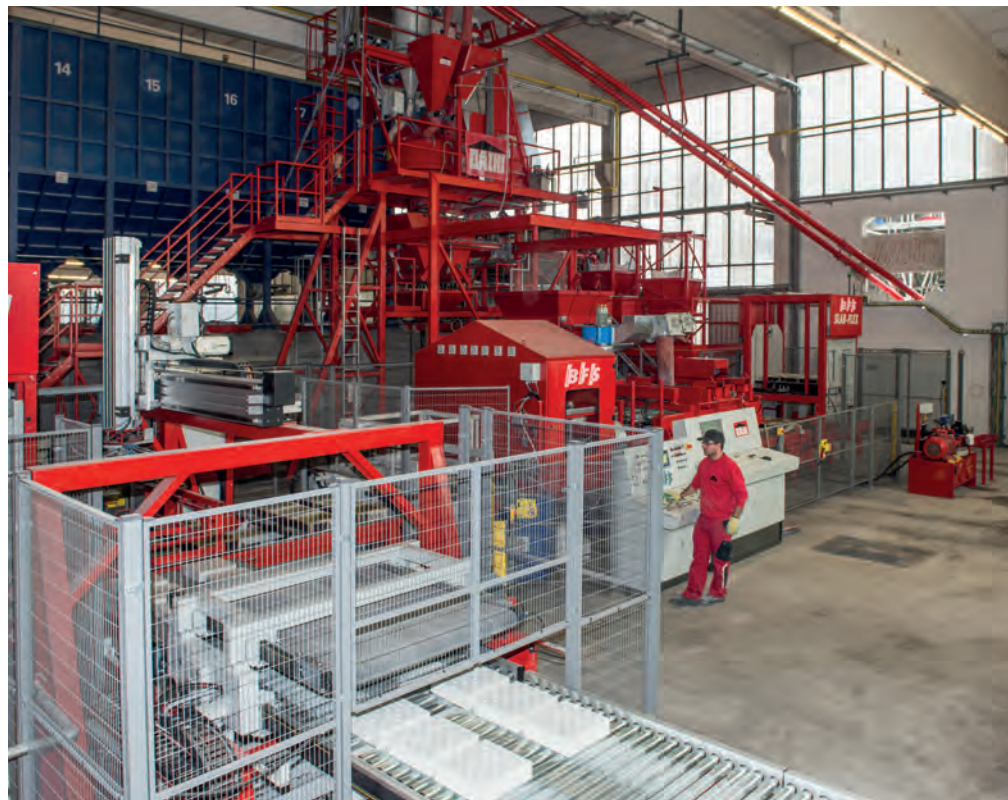
Die SlabFlex-Anlage mit Mischanlage im Hintergrund
