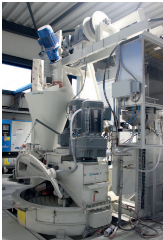
CRE Panel a opté pour un malaxeur conique Kniele KKM 250/375.
