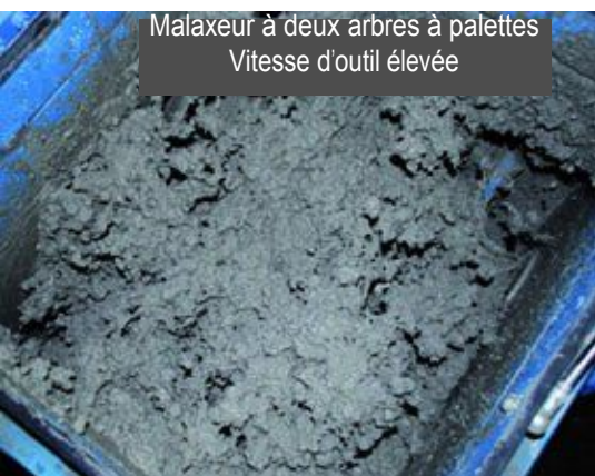
Fig. 3: vitesse d'outil élevée, malaxeur à deux arbres à palettes
