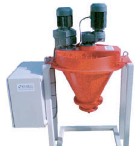
Version de base statique avec cuve 25 l
