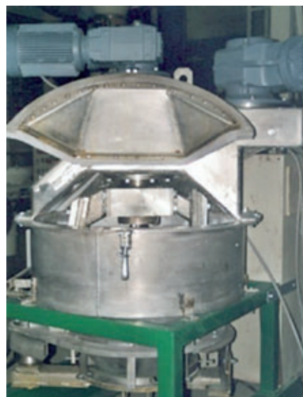
Malaxeur de laboratoire à cuve conique KKM-L 100 /150
