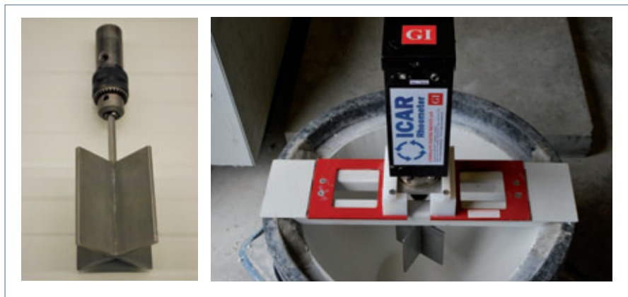
Figure 5 : adaptateur pour corps de révolution à pales dans le malaxeur (gauche) et rhéomètre ICAR dans un cône aux dimensions identiques à celles du malaxeur conique (droite)
