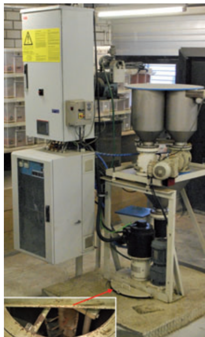
Figure 1 : malaxeur conique (Kniele) avec dispositifs de dosage pour utilisation en laboratoire
