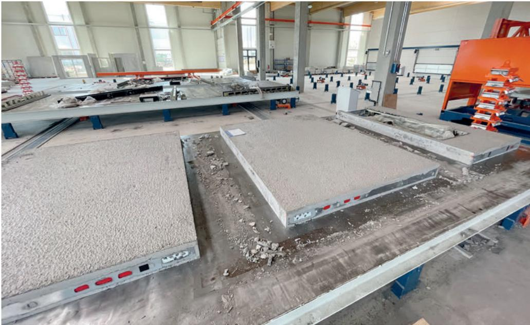
*Des éléments en béton CBS après le décoffrage et avant leur transport vers la zone de stockage extérieure*
