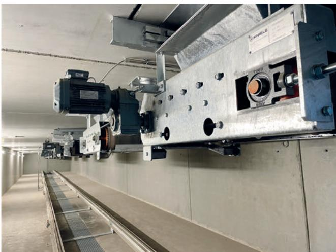
*Le dosage des granulats est effectué au moyen de 12 tapis transporteurs (deux par silo)*
