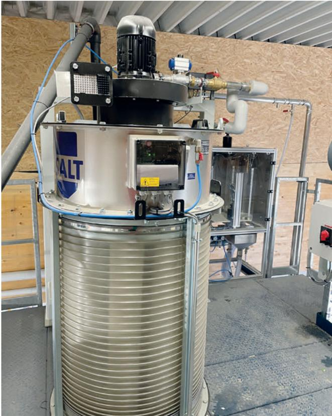
Au-dessus du malaxeur sont placés, entre autres, un système d'extraction de poussière et une balance à adjuvants fabriquée par Würschum
